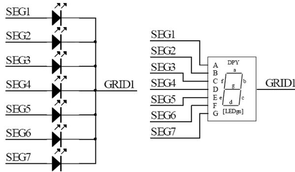
如图所示，如果让该数码管显示“0”，那么在 GRID1 为低电平时 SEG1、SEG2、SEG3、SEG4、SEG5、SEG6 为高电平，SEG7 为低电平，只需在 00H 地址单元里面写数据 3FH 就可以让数码管显示“0”。
