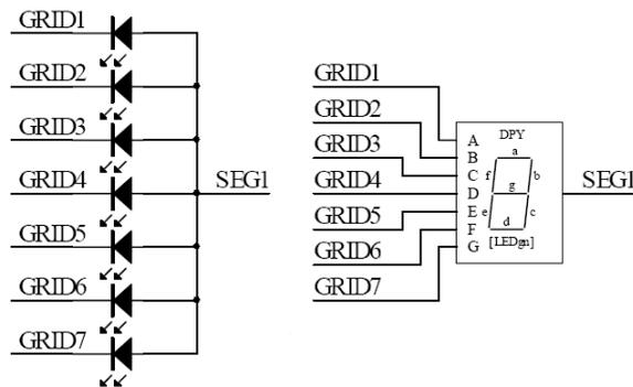
如图所示，如果让该数码管显示“0”，那么在 GRID1、GRID2、GRID3、GRID4、GRID5、GRID6 为低电平时 SEG1 为高电平，在 GRID7 为低电平时 SEG1 为低电平。
